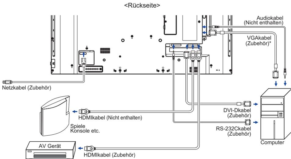
\* Das VGA-Kabel ist nicht im Lieferumfang enthalten. Wenn ein qualitativ niedriges VGA-Kabel verwendet wird, kann dies elektromagnetischen Störungen verursachen. Bitte kontaktieren Sie das iiyama Support Center in Ihrem Land, wenn Sie den Anzeige über den VGA-Eingang anschließen wollen.
