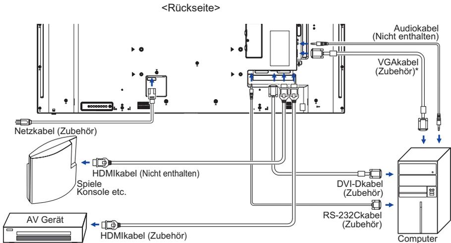
\* Das VGA-Kabel ist nicht im Lieferumfang enthalten. Wenn ein qualitativ niedriges VGA-Kabel verwendet wird, kann dies elektromagnetische Störungen verursachen. Bitte kontaktieren Sie das iiyama Support Center in Ihrem Land, wenn Sie den Anzeige über den VGA-Eingang anschließen wollen.
