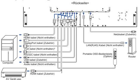
\* Das VGA Kabel ist nicht im Lieferumfang enthalten. Wenn ein Qualitätiv niedriges VGA Kabel verwenden wird, kann dieses elektromagnetischen Störungen verursachen. Bitte kontaktieren Sie das iiyama Support Center in Ihrem Land, wenn Sie den Monitor über den VGA-Eingang anschließen wollen.
