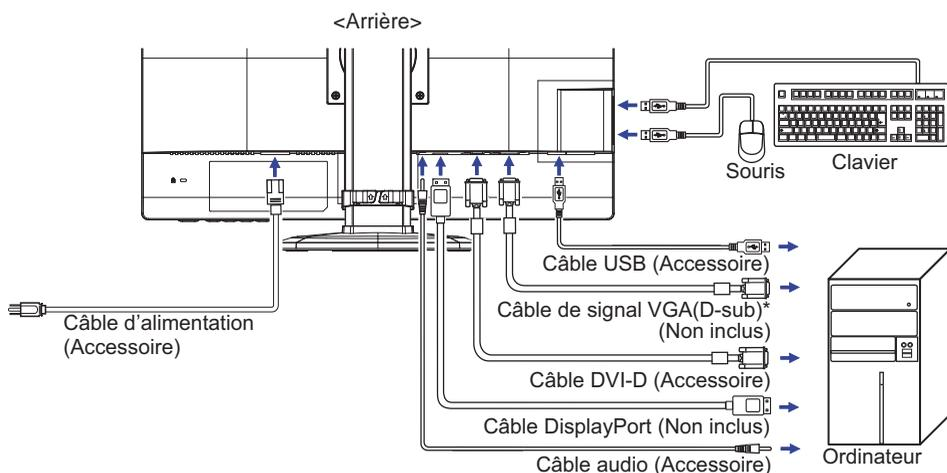
\* Le câble VGA (D-Sub) n'est pas fourni avec le moniteur, vous devez utiliser un câble VGA (D-Sub) dédié spécialement à ce modèle. Veuillez contacter le service après vente iiyama dans votre pays, si vous souhaitez connecter votre moniteur via l'entrée VGA.
