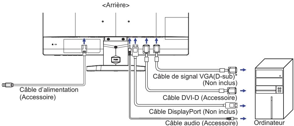
\* Le câble VGA (D-Sub) n'est pas fourni avec le moniteur, vous devez utiliser un câble VGA (D-Sub) dédié spécialement à ce modèle. Veuillez contacter le service après vente iiyama dans votre pays, si vous souhaitez connecter votre moniteur via l'entrée VGA.
