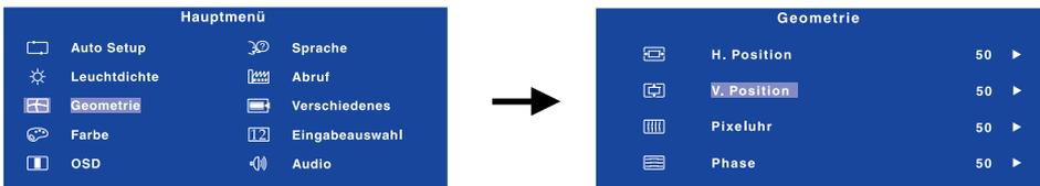
Verwenden Sie dann die Tasten ◀/▶, um die Einstellungen für die vertikale Position zu ändern. Hierbei sollte die vertikale Position der allgemeinen Anzeige ebenfalls entsprechend angepasst werden.
