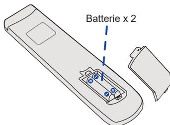
③ Una volta installate le batterie, richiudere il coperchio facendo attenzione ad agganciare la clip di sicurezza.
