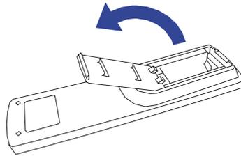
② Alignez et insérez deux piles AAA en suivant les indications PLUS et MINUS (comme indiqué sur la télécommande).
